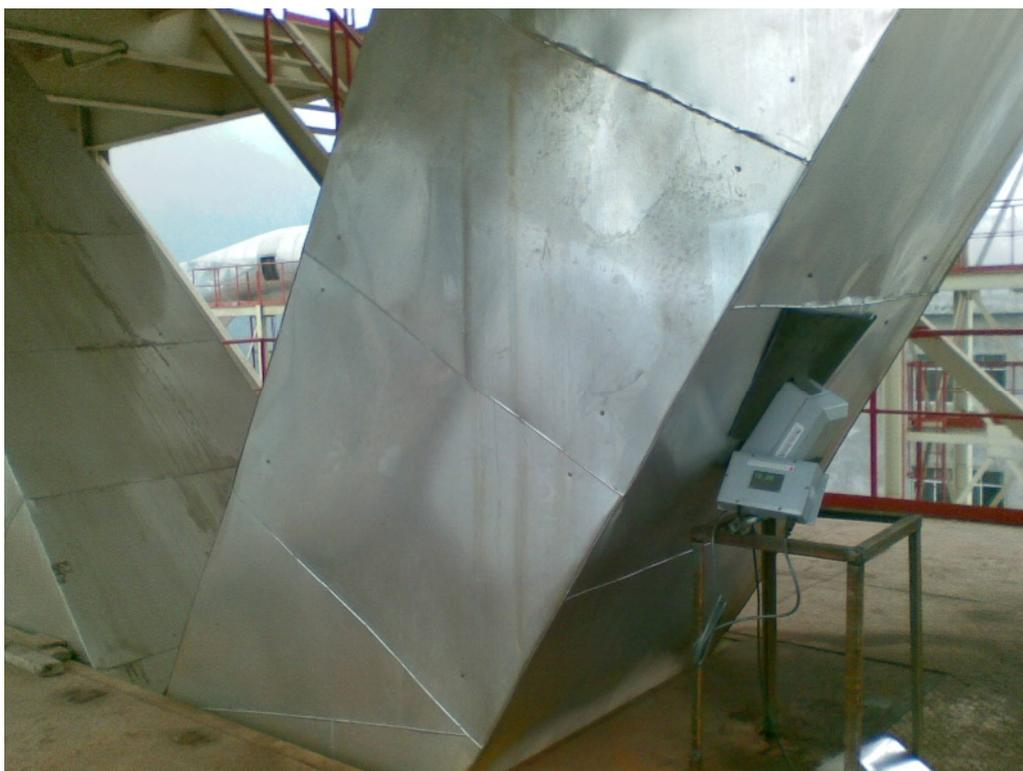
图 11.用黑色材质的物料遮挡探头
