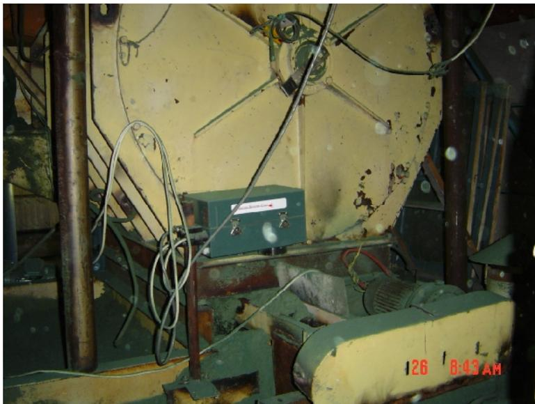
图 8. 星型下料器的安装例子
