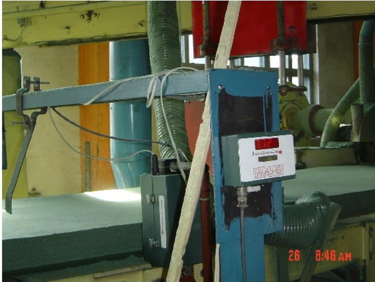
图 4. 探头也可以水平安装
