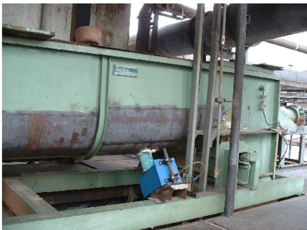
图 6. 防火螺旋的安装例子，很多早期的进口生产线采取这样的安装。
